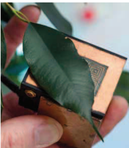
Bepaling van bladgroengehalte en bladwatergehalte met een draagbare NMR sensor.
